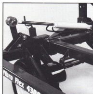
VF 4200/4300/4000 Hopfällning med dubbelverkande hydrauliskcylindrar.
