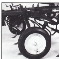
VF 4200/4300/4000 Gummihjul 24x8,00 - 14,5" med vevinställning är standard i kombination med VFM-pinnen.
